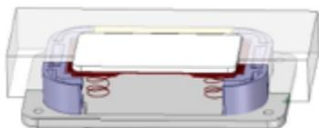
Für Türen mit einer Dicke von mehr als 27 mm können Sie die NS 105 einbauen.
